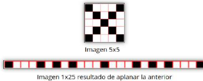
Figura 74: Ejemplo de aplanamiento de una imagen en 2D (5x5) a una forma en 1D (1x25)
